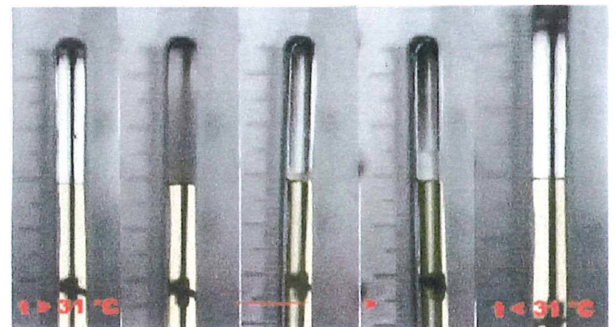
Phasenübergang vom überkritischen nach dem unterkritischen Bereich der Mischungslücke eines CO 2 -Öl-Gemisches
