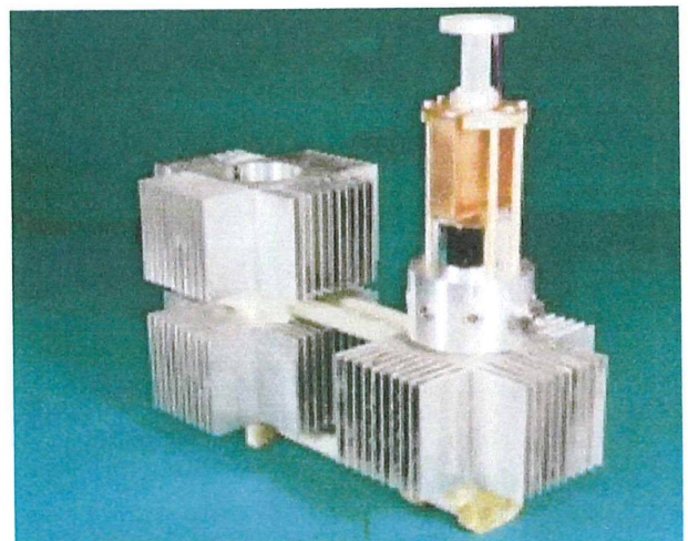
Kühlsystem für die hochauflösende magnetische zerstörungsfreie Werkstoffprüfung
