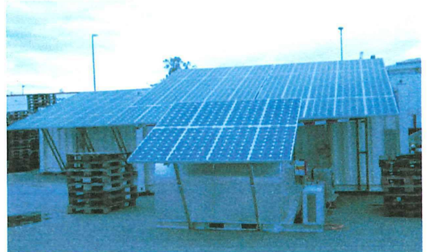
Werkstest Solar-Kühlcontainer und Solar-Wasserkühler beim Hersteller
