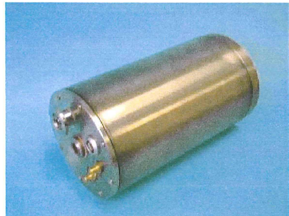
Lageunabhängiger Kryostat aus Titan für mobile Prüfaufgaben (Nietreihen der Flugzeugaußenbeplankung)
