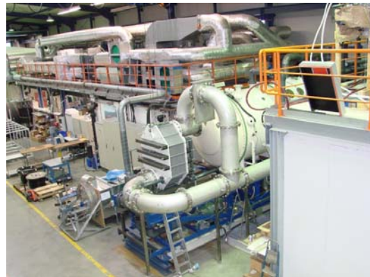
Bild 2: Verdampfer-Kondensator für Meerwasserentsalzung im Test
