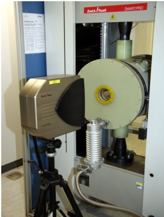
Bild 3: Universalprüfmaschine mit Kryostat und Laser-Speckle-Messsystem
