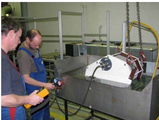
Bild 1: Dichtheitsprobe des Plattenwärmeübertragers
