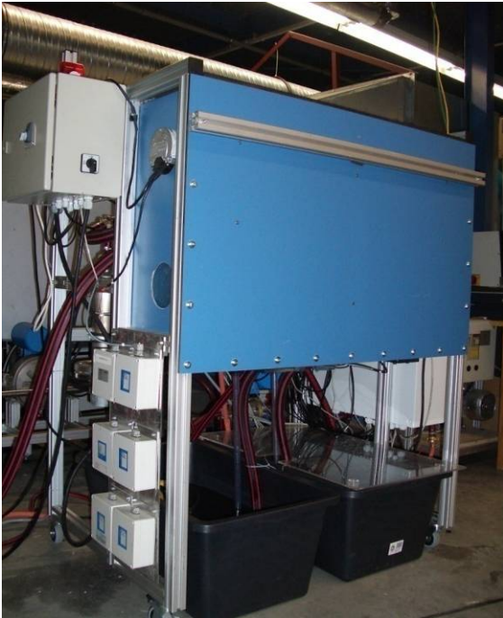
Bild: Prototypgerät zur Kaltwasserbereitung mit erweiterter Messtechnik
