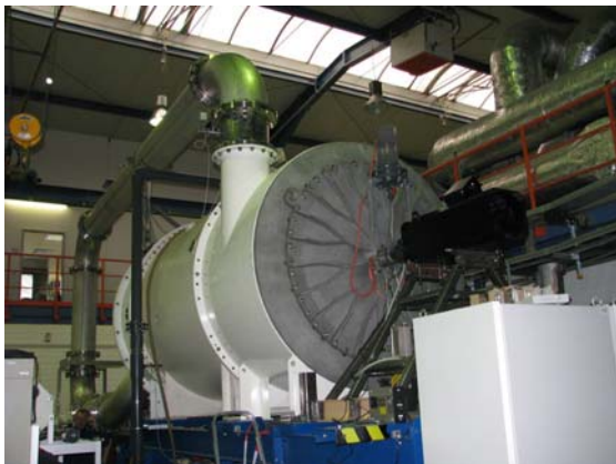
Bild: Versuchsverdichter auf dem ILK Verdichterprüfstand
