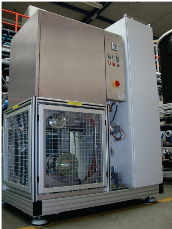
Bild 2: Thermobox und Antriebssektion zur Prüfung von Fahrzeugverdichtern
