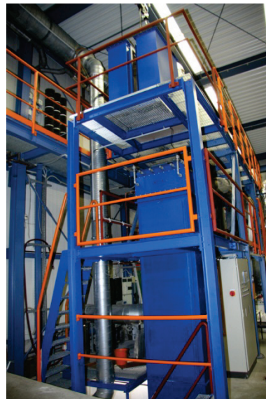
Bild 3: Versuchstand zur Untersuchung von Filterelementen bis 6 m Längen
