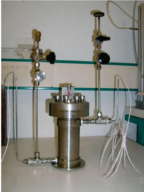
Bild 2: Messzelle zur Messung von Wärmeleitfähigkeiten unter erhöhtem Druck
