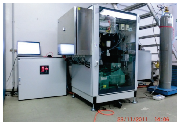
Bild 1: \text{CO}_2 -Wärmepumpe im Test
