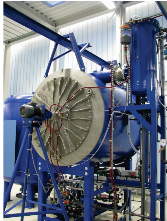
Bild 1: Vakuum-Eisspeichersystem in der WSH Zwickau
