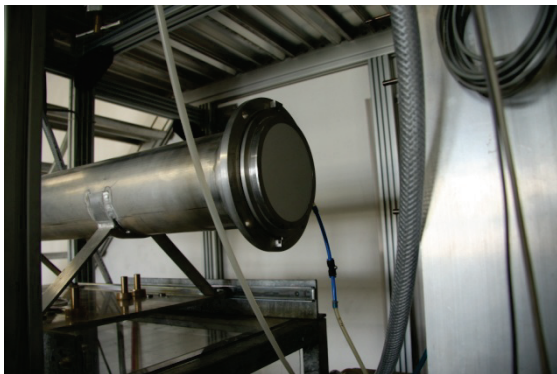
Bild 2: Filterprüfstand nach VDI 3926/DIN ISO 11057
