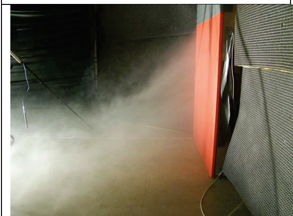
Bild 1: Akustische und hydraulische Untersuchungen des Akustikpaneels im Labor
