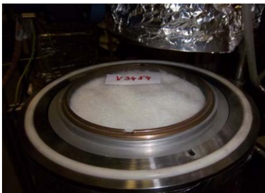
Ronde mit eingespanntem Filtermaterial
