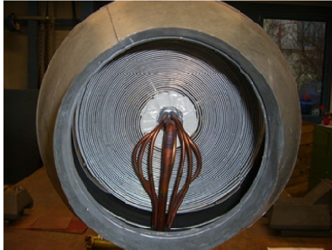
Bild 3: Luftkühler aus MPE-Rohr
