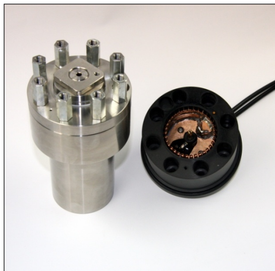
Bild 1: Messzelle zur Messung der elektrischen Eigenschaften
