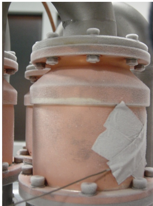
Bild 3: Vereisung des Kaltkopfs des 3Z-PTK
