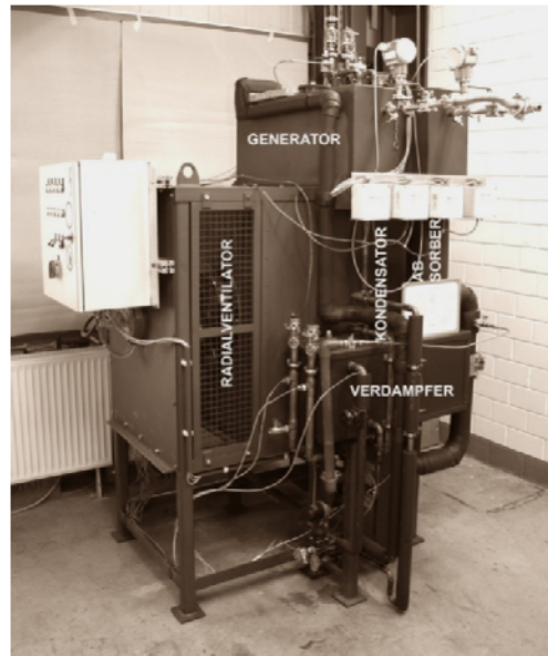
Bild 1: Komponenten-Demonstrator einer luftgekühlten Klein-AKM
