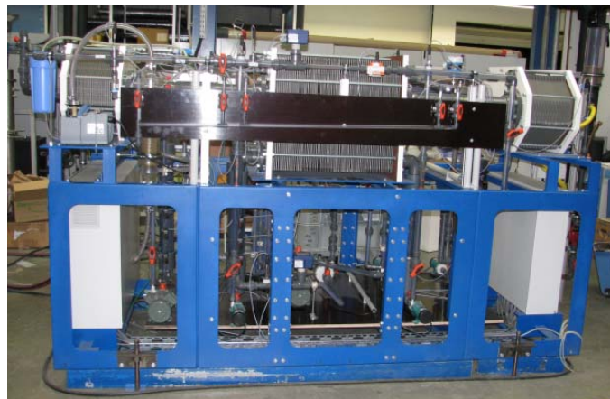
Bild 1: Single-Quattro-MED-Anlage im Labortest
