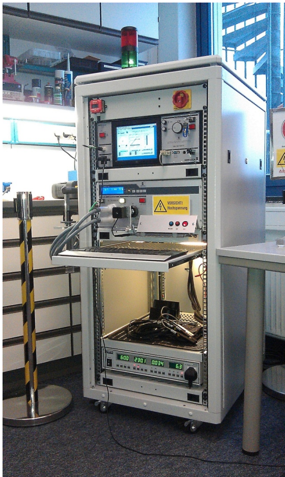
Bild 1: Hochspannungsprüfplatz (Wechsel- und Gleichspannung) für Komponenten von Hermetikverdichtern
