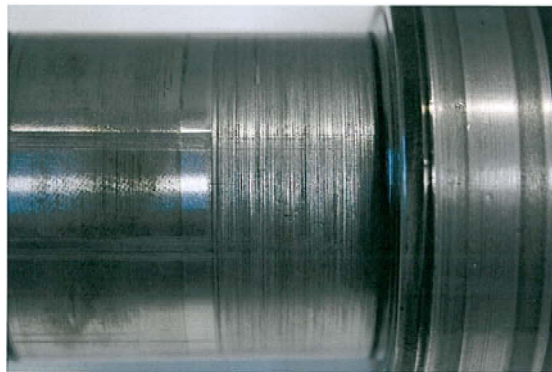
Bild 1: Verdichterschaden - Wälzlager auf der Welle verschoben
