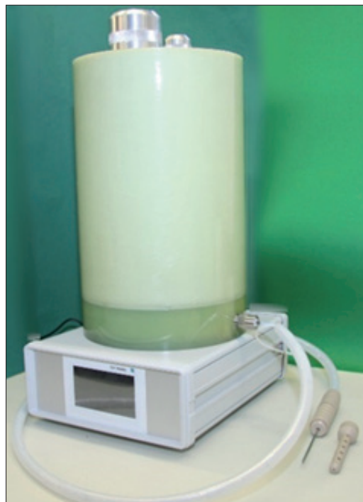
Abbildung 1: Modernisiertes LN 2 -Versorgungsgerät
