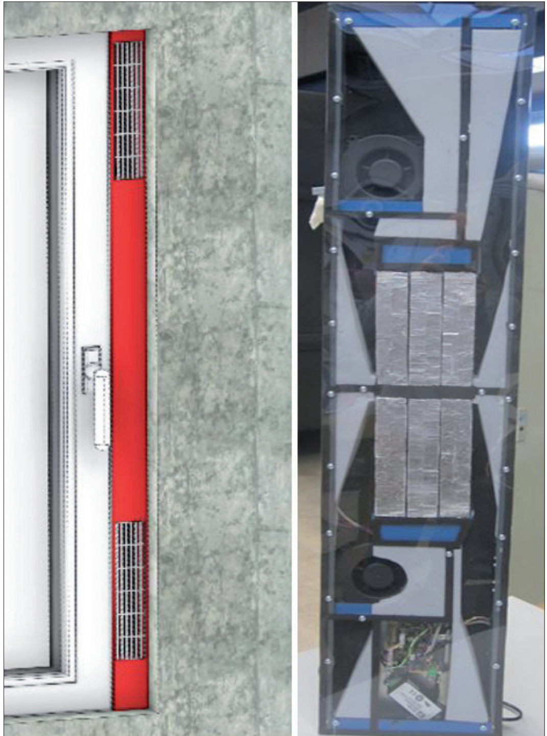
Abbildung 2: entwickeltes Fensterlüftungssystem mit Wärmerohr-Wärmübertrager und Einbaulage mit Fenster
