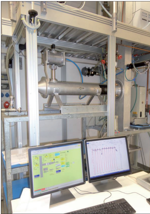
Abbildung 1 und Abbildung 2: Prüfstand für die Untersuchung abreinigbaren Filtermedien bei Einsatz von Filterhilfsmitteln und/oder Adsorptionsmitteln (Gasreinigung)
