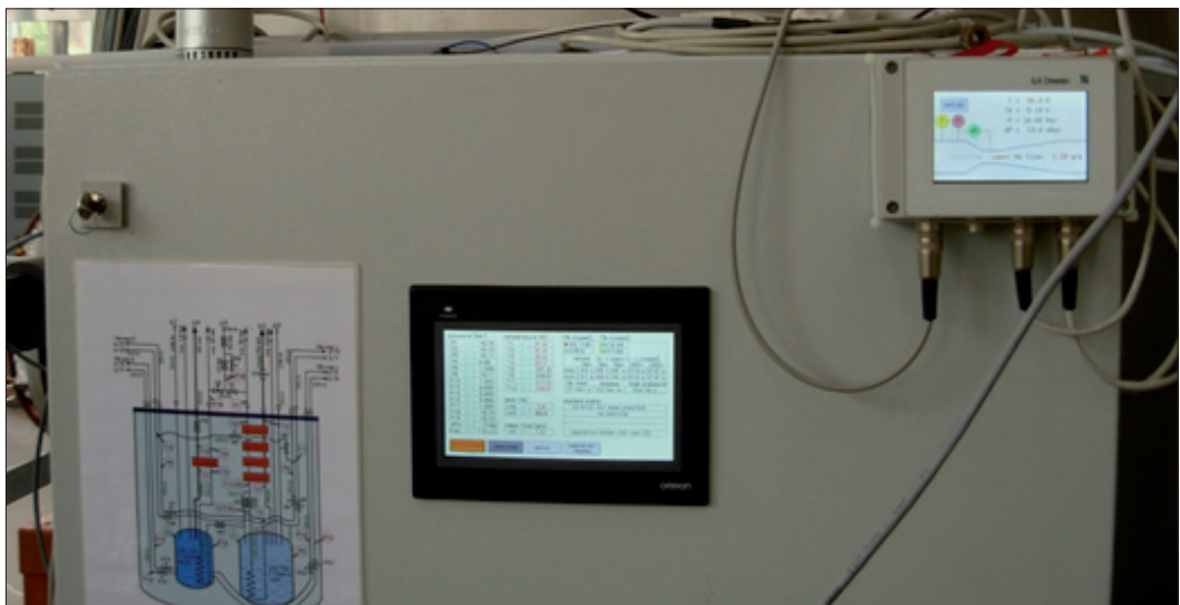
Abbildung 2: Blick auf das Bedienelement des Helium Teil-Verflüssigers des ILK Dresden. In der rechten oberen Ecke sieht man das Display des entwickelten Massenstrommessgerätes.
