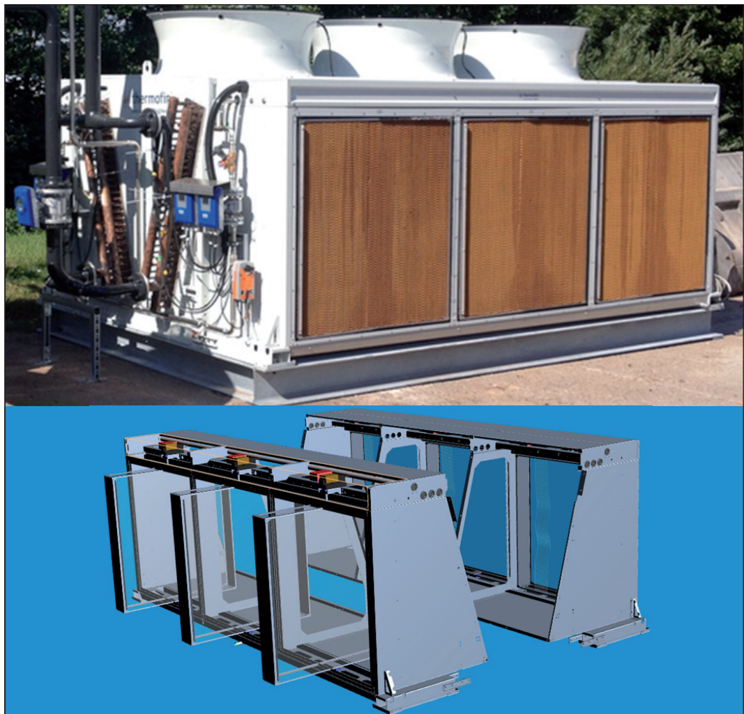
Abbildung 2: Versuchsmuster eines trockenen Rückkühlers mit adiabater Luftvorkühlung
