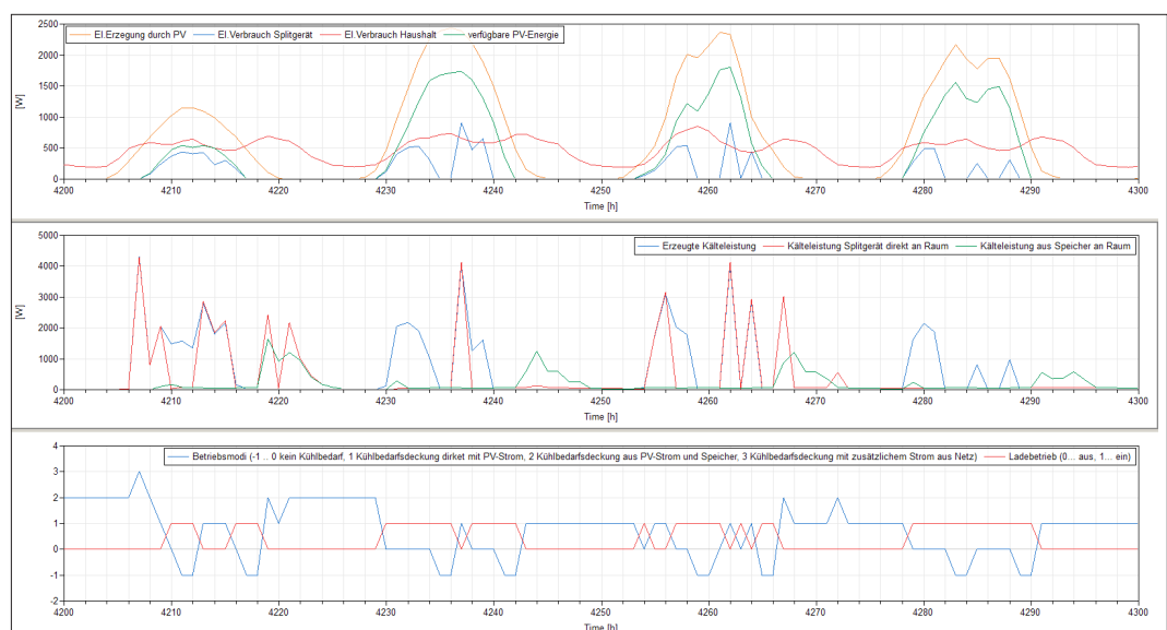
Abbildung 3: Simulationsergebnis beim Einsatz einer PID-Regler-Kaskade
