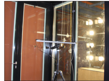
Abbildung 3: Raumströmungslabor der ILK Dresden gGmbH mit Messtechnikausstattung und Solar-Simulator
