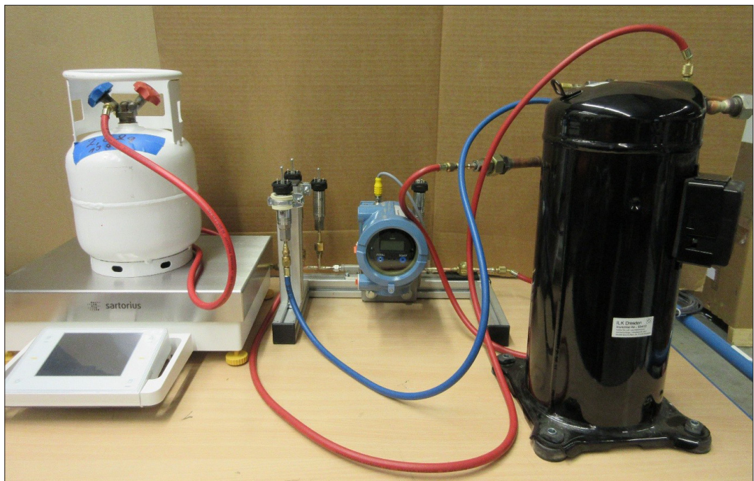
Abbildung 3: Versuchsaufbau für Überstromversuche
