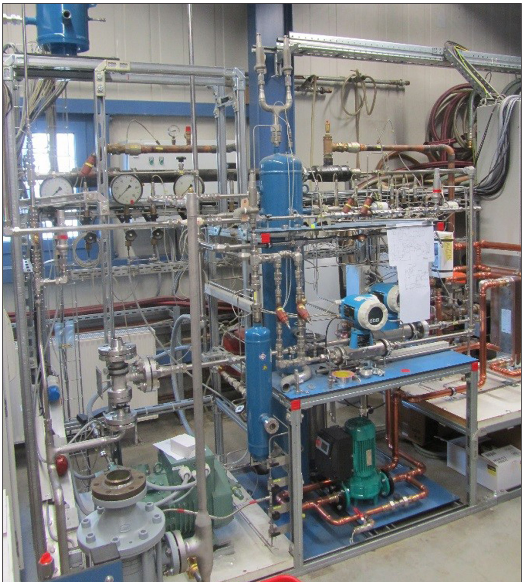
Abbildung 3: Prüfstand für Ejektor-Versuche
