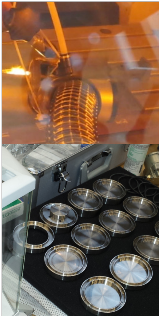
Abbildung 1: Versuchsaufbau zur Bestimmung der Laser-Emissionen
