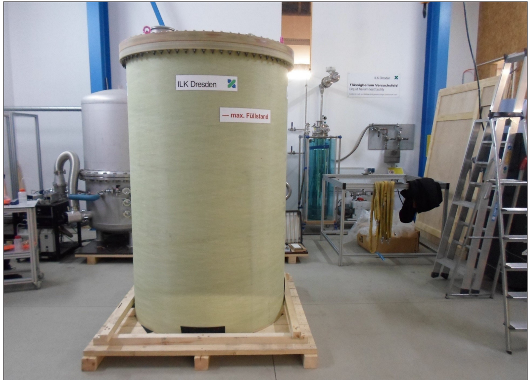
Abbildung 2: Kryostat zur Kühlung von HTSL-Spulen
