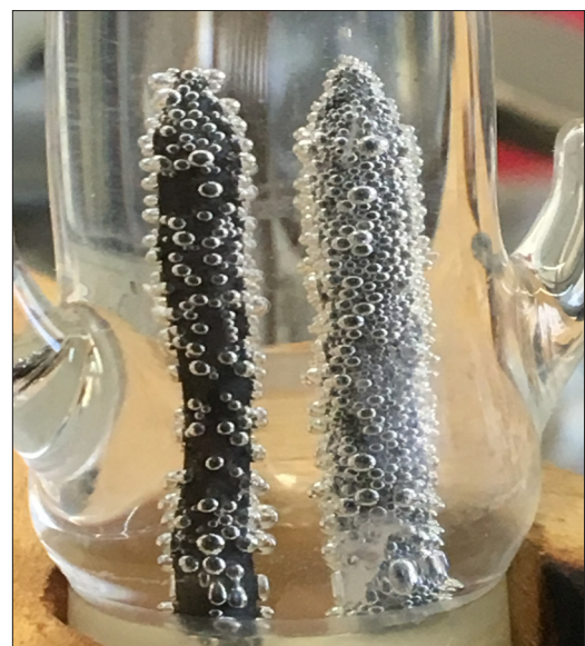
Abbildung 1: Entstehung von Sauerstoff (links) und Wasserstoff (rechts) an zwei Graphitelektroden
