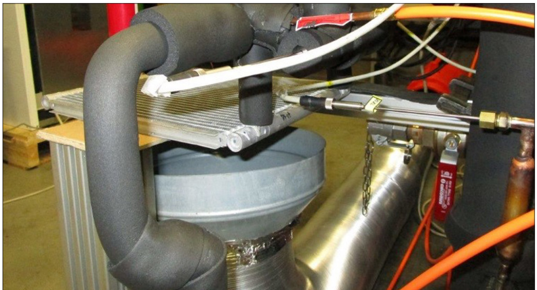
Abbildung 2: Versuch mit horizontaler Einbaulage
