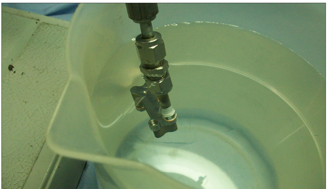
Abbildung 4: Dichtheitsprüfung eines kompletten Mikrowärmeübertragers
