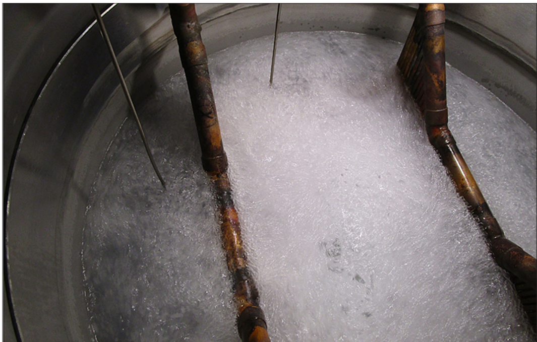
Abbildung 3: Sublimierendes Kohlendioxid im Lösungsmittel
