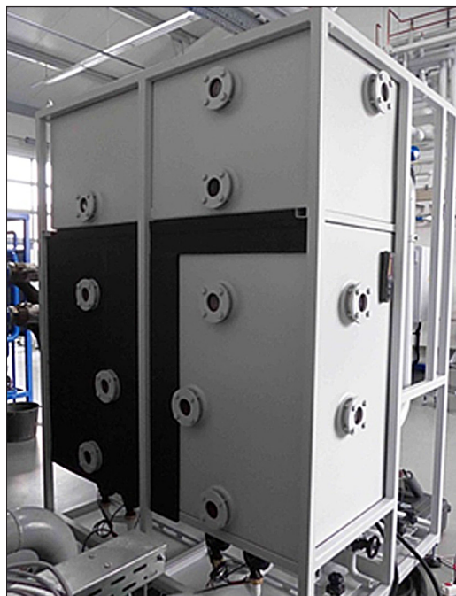
Abbildung 2: Funktionsmuster mit eingebauten asymmetrischen Plattenwärmeübertragern und der Funktionseinheiten Niederdruck (Verdampfer, Absorber) und Hochdruck (Kondensator, Generator)
