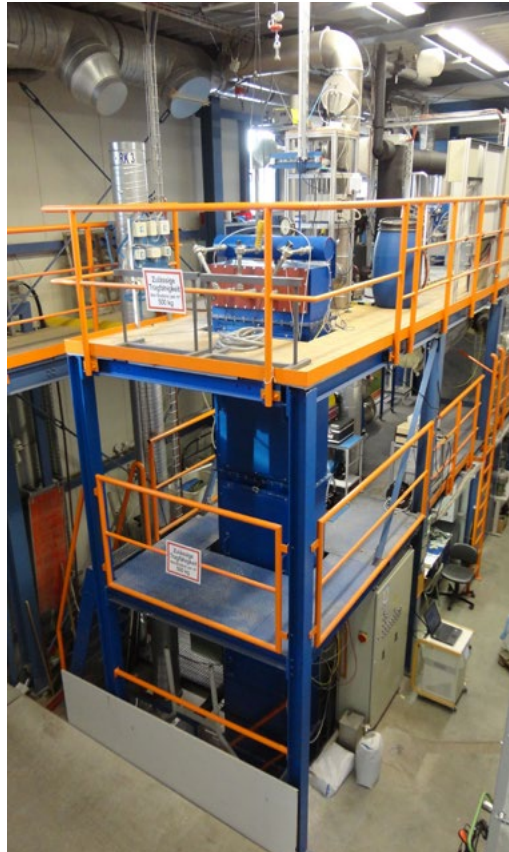
Bild 2: Filterelemente-Prüfstand im ILK Dresden
