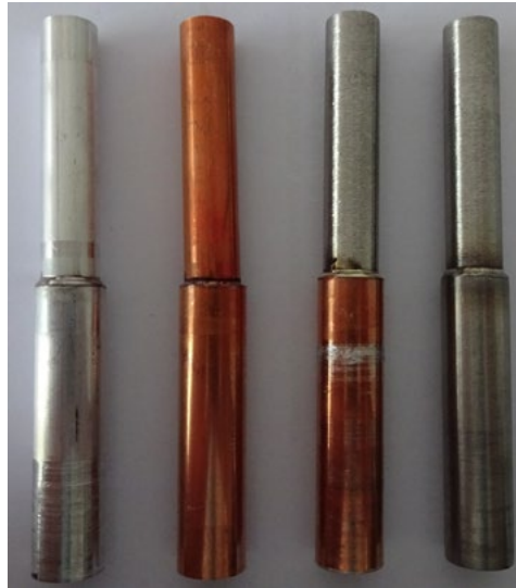
Bild 2: Lasergeschweißte Proben unterschiedlicher Materialien
