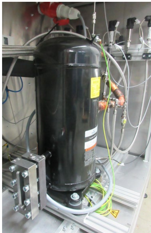
Bild 1: Scrollverdichter beim Lebensdauererprobung
