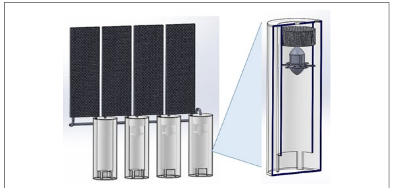
Bild 2: CAD-Modell des geplanten Systems in 4-zyklischer Ausführung (links) und Detailsicht eines Zylinders ohne Flüssigkeitskolben mit Wells-Turbine und Regenerator (rechts)
