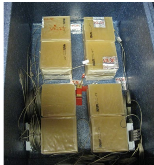
Bild 1: Messung der Temperaturverteilung in einer Kühlbox
