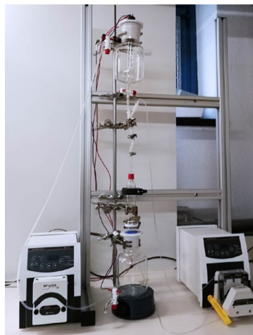
Bild 1: Funktionsmuster einer Prüfeinheit zur Degradationsprüfung biologisch abbaubarer Medizinprodukte
