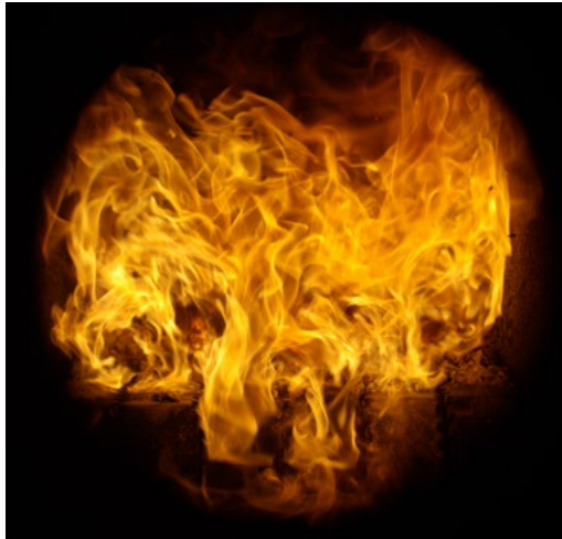
Bild 1: Thermische Umsetzung von Holz in einem Biomassekessel
