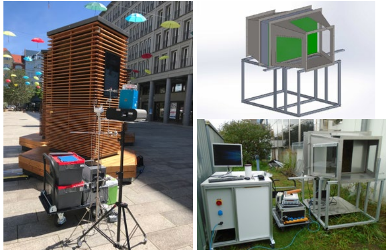
Bild 2: Messungen an Moos-Luftfiltern in Berlin und Prüfaufbau im Versuchsfeld des ILK Dresden
