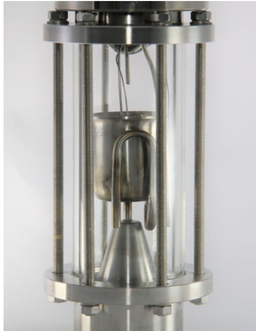
Bild 2: Extraktionsapparatur als Durchsichtsdemonstrator
