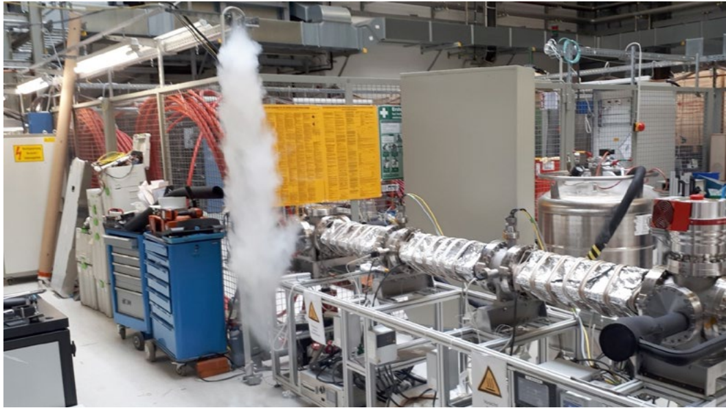
Bild 1: Kryogene Prototyp-Quadrupolkammer im Versuchsfeld der GSI
