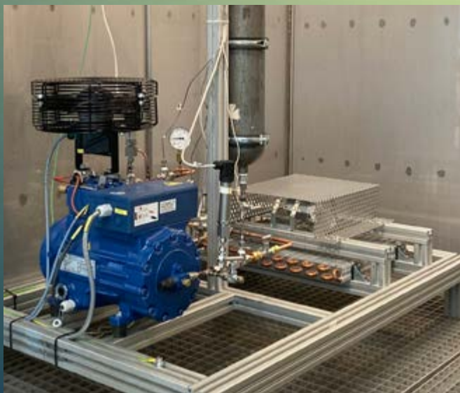
Bild 1: Experimenteller Aufbau einer Gasschleife zum Test der Schmierwirkung des ausgewählten Hybrid-Fluids
