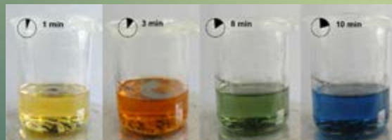
Bild 2: Laborversuche zur Aufbereitung von LiBr-Lösung
