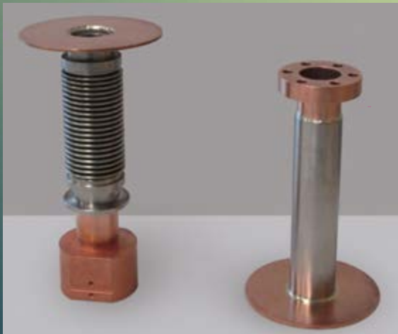
Bild 1: Schlüsselkomponenten für die Prüfungen mit Röhrchen-Halterung und Längenkompensator, vor Einbau in die Vakuumkammer
