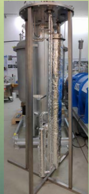
Bild 2: Neon-Kryosystem mit isoliertem Wärmeübertrager, Turbine und Verbraucher
