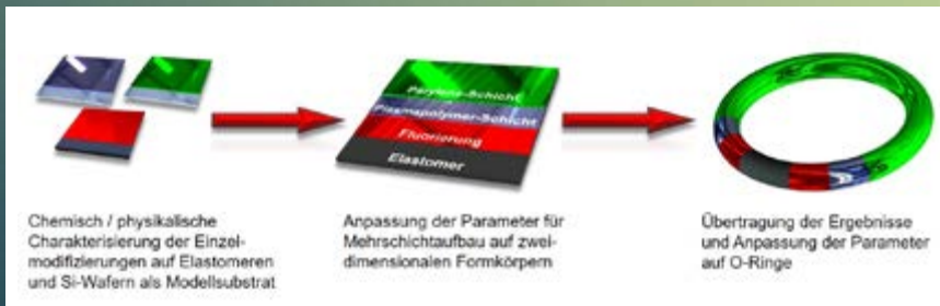
Bild 1: Schematische Darstellung eines Mehrschichtaufbaus von der Charakterisierung der Einzelschichten bis zum fertigen O-Ring
