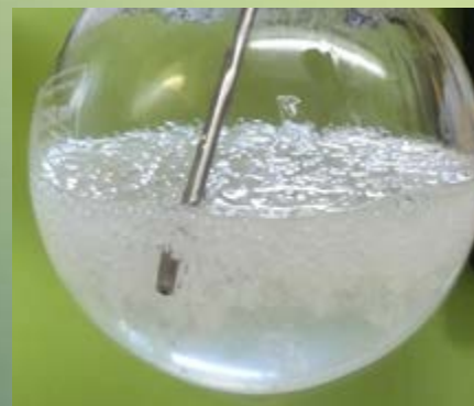
Bild 2: Sublimierendes \text{CO}_2 im Ester bei -78\text{ }^\circ\text{C} und 1 bar
