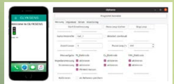
Bild 2: Abfrage der Messwerte mittels Smartphone (links) und Parametrisierung über integriertem Webserver (rechts)
