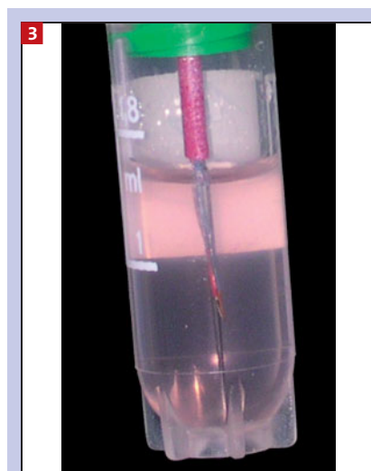
3 Präparation der Messstelle (TH) in einem Kryoröhrchen
